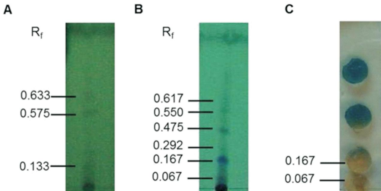
Figura 1. Placas de cromatografía de capa fina empleando como fase móvil cloroformo:metanol:ácido fórmico (85:15:1), revelado con luz UV ( $\lambda=260$  nm). A) del extracto metanólico de paja de trigo. B) del extracto metanólico de poda de vid (EMPV). C) placa cromatográfica conteniendo las fracciones de elución del extracto metanólico de poda de vid (EMPV), ABTS al 0.2%, y discos de agar conteniendo el secretoma y micelio de *L. edodes*.
